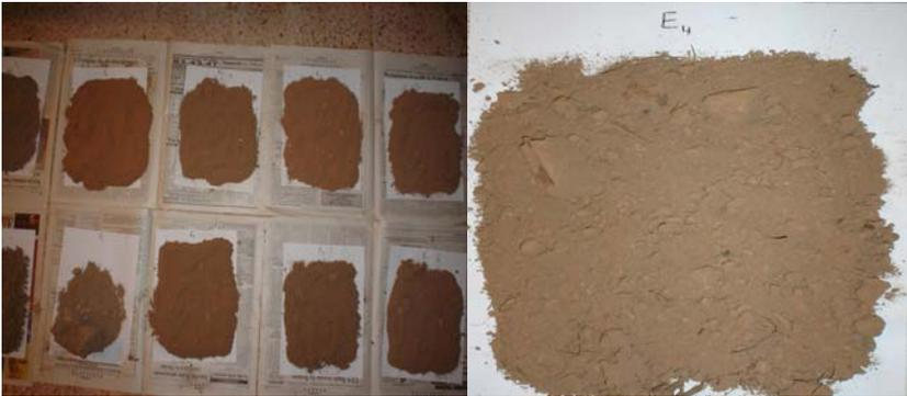
Nous avons fait une analyse granulométrique afin de déterminer les proportions des sables, limons et argiles. Ensuite nous avons procédé aux analyses des paramètres suivants :
